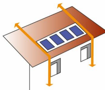
Implantation horizontale Alignement du champ de capteurs avec les ouvertures de façades
